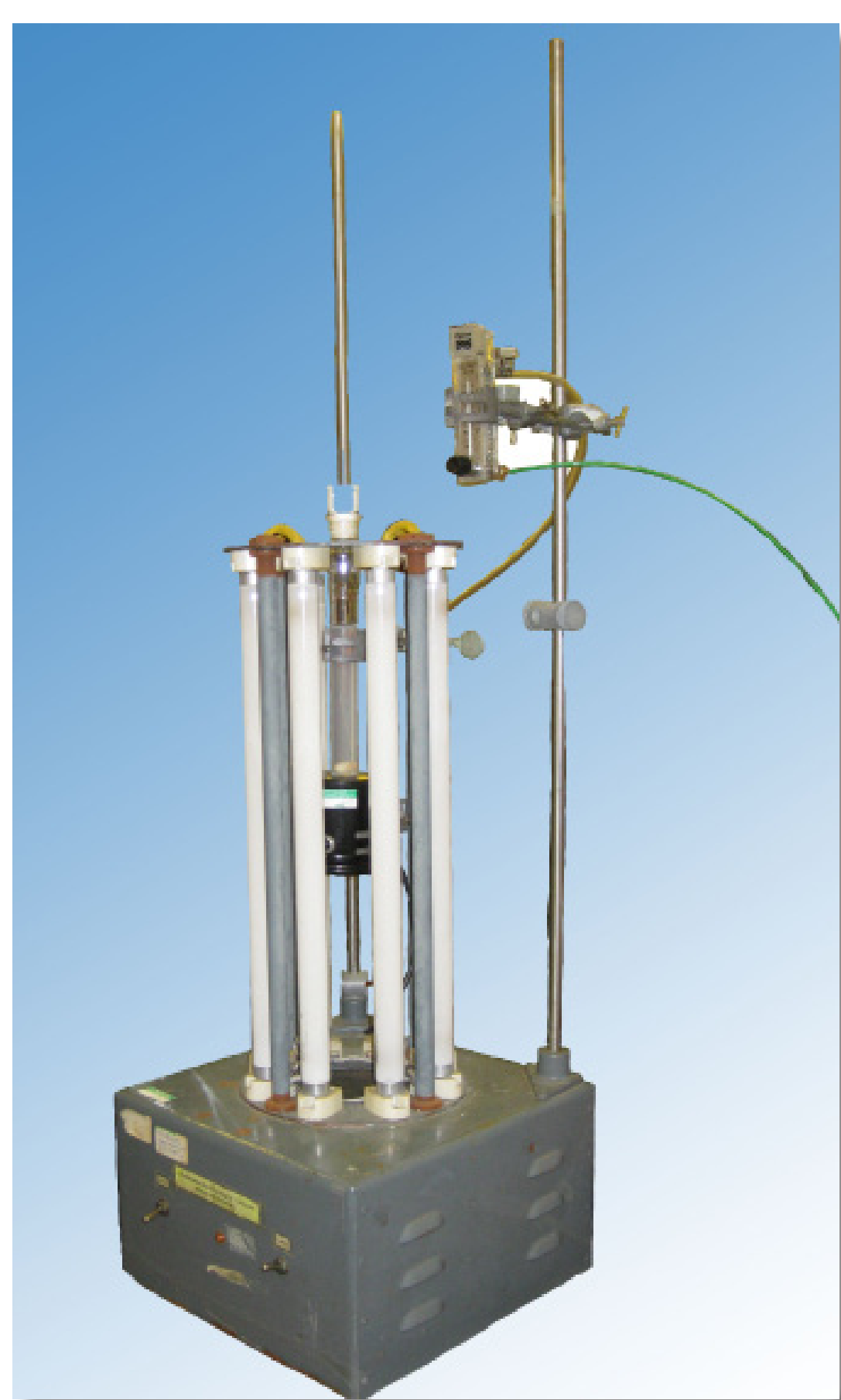
Abb. 2: Der für die Experimente genutzte Versuchsaufbau; ein von sechs UV-Lampen umgebener Quarzglas-Reaktor
